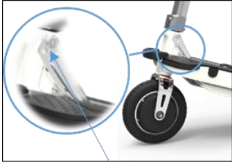
Figuur 22 Stuurkolom hoekinstelling schroeven
