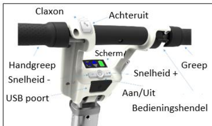
Figuur 23 Overzicht bedieningspaneel
